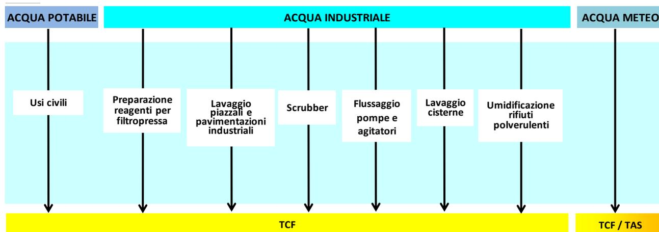
Il Disidrat, così come gli altri impianti ubicati nel comparto, impiega esclusivamente acqua industriale nel processo (Figura 40). In particolare, le principali esigenze idriche sono relative alla sezione di filtropressatura, in termini di preparazione dei reagenti e di lavaggio delle tele.
