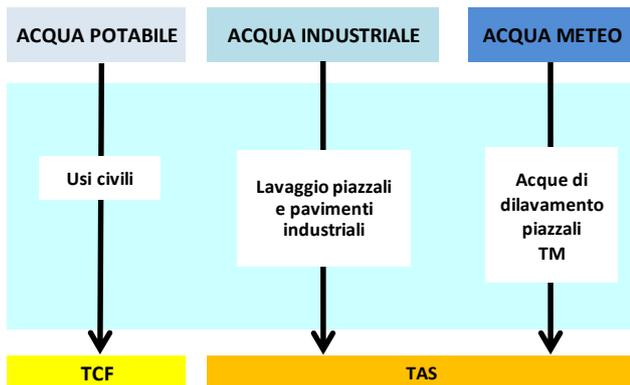
Come visibile dalla Figura 36, l'acqua industriale è impiegata unicamente nelle operazioni di lavaggio e pulizie piazzali/impianto per la quale nel 2020 è stato registrato un consumo pari a 218 m<sup>3</sup>. L'acqua potabile è invece utilizzata per gli usi civili e dal contatore è stato rilevato un consumo pari a 175 m<sup>3</sup>.
