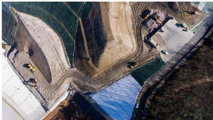
La copertura finale, realizzata in accordo con quanto previsto dal D.Lgs. 36/2003 e s.m.i., ha lo scopo di isolare definitivamente i rifiuti depositati nel corpo di discarica, permettere la realizzazione delle opere a verde di ripristino ambientale e prevedere la restituzione del sito alla collettività. La barriera multistrato sarà costituita, dal basso verso l'alto, dai seguenti elementi:
