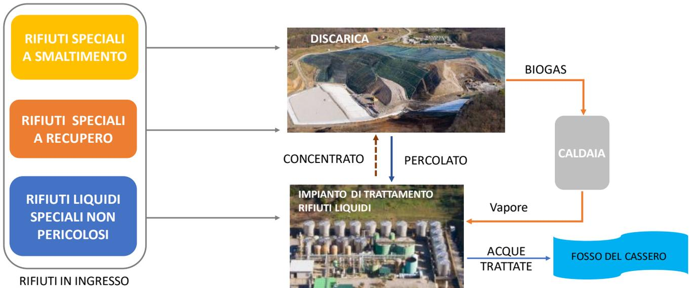
Tutti i rifiuti in ingresso alla discarica sono sottoposti ad operazioni di pesatura, di controllo della regolarità della documentazione di accompagnamento e registrazione del movimento presso il Servizio Accettazione. I mezzi, dopo aver transitato attraverso la pesa, si dirigono verso l'area di conferimento percorrendo la viabilità dedicata nel rispetto delle norme comportamenti di sicurezza.
