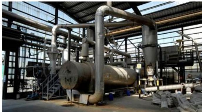
Il fango essiccato è poi miscelato con una parte del fango prodotto dalle centrifughe per ridurne la polverosità ed avviato a smaltimento in discarica.
