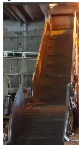
vengono alimentati tramite carrello elevatore alla fossa di carico interrata ed inviati mediante nastro alla pressa per la riduzione volumetrica.
