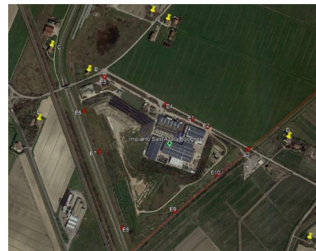
LOCALIZZAZIONE DEI PUNTI DI RILEVAZIONE ACUSTICA PRESSO I RICETTORI ED AL PERIMETRO DEL SITO (FONTE: VERIFICA DI IMPATTO ACUSTICO 2025)
