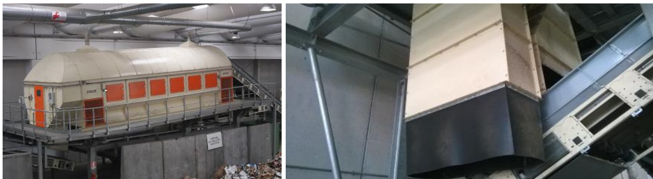
Figura 7 Particolare del vaglio rotante e del deferrizzatore
