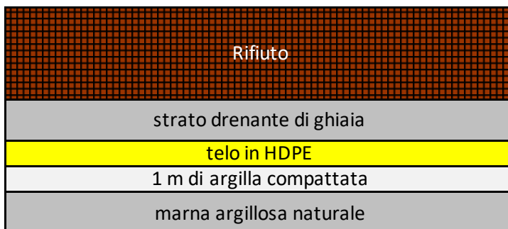
Figura 37 Struttura del fondo della discarica
