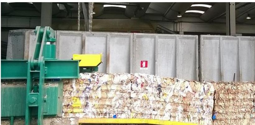
I rifiuti conferiti o provenienti dalla linea L1 sono accumulati e stoccati provvisoriamente nelle aree in prossimità della tramoggia di carico dove subiscono, se necessario, una pre-cernita per eliminare le frazioni estranee ingombranti. Successivamente vengono alimentati tramite carrello elevatore alla tramoggia di carico interrata e inviati mediante nastro alla pressa per la riduzione volumetrica. L'alimentazione della pressa con il rifiuto
