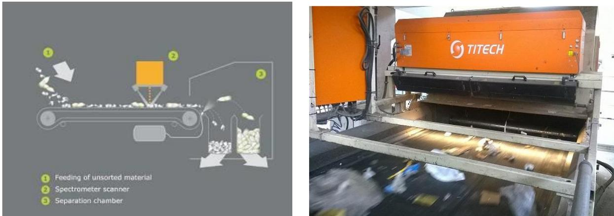
NOTA: Il materiale da smistare (1) è condotto ai sensori in modo omogeneo su un nastro trasportatore.
