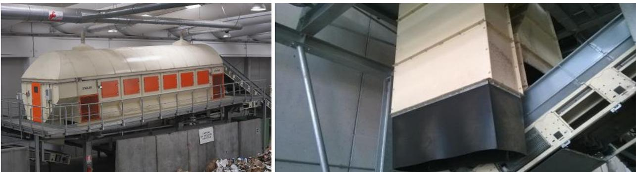
La frazione sottovaglio, previo passaggio a deferrizzatore per la separazione dei metalli ferrosi, è inviata alla selezione ottica nella quale la separazione dei materiali da recuperare è effettuata tramite n. 1 lettore ottico in grado di identificare i materiali e separarli tramite un getto di aria compressa.
