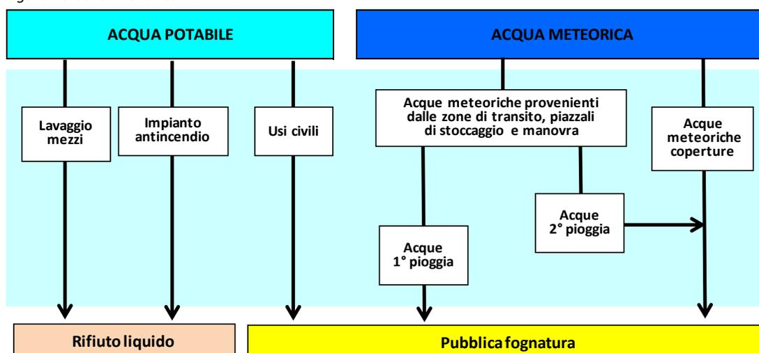
L'approvvigionamento idrico dell'impianto avviene attraverso il collegamento all'acquedotto civile comunale di Ferrara. La fornitura di acqua potabile è realizzata mediante allaccio a dorsale esistente di Herambiente S.p.A. per essere distribuita, previo passaggio in un contatore, alle varie aree dell'impianto. La rete interrata fornisce acqua all'edificio di selezione e trattamento, alla tettoia ricovero mezzi per l'area di lavaggio, agli uffici
