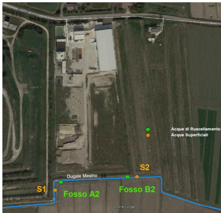
**Figura 2** - Planimetria discarica ACR di Mirandola con rete di monitoraggio delle acque superficiali e meteoriche di ruscellamento
