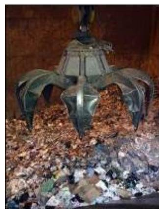
I rifiuti sono scaricati nella fossa di ricezione tramite dieci porte di accesso e tramite l'utilizzo di due (uno di riserva all'altro) carriponte dotati di benne idrauliche sono immessi nelle tramogge di alimentazione per la combustione. Rappresentiamo i grafici indicanti la quantità di rifiuti trattati dal termovalorizzatore nell'ultimo triennio.
