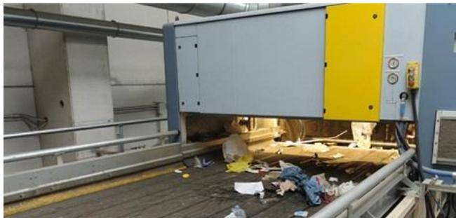
La linea è altamente automatizzata e gli operatori effettuano esclusivamente un controllo di qualità sui rifiuti in uscita dalle linee di trattamento. Il rifiuto oggetto dei trattamenti è inviato mediante nastri trasportatori alla pressa posta in coda alla linea stessa per la riduzione volumetrica. Le frazioni separate dalla selezione e conferite in contenitori d'accumulo (sili) sono anch'esse trasferite alla pressa posta in coda alla linea per la riduzione volumetrica.
