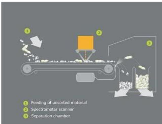
NOTA: Il materiale da smistare (1) è condotto ai sensori in modo omogeneo su un nastro trasportatore.
