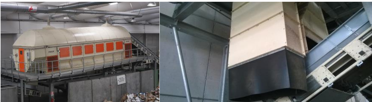
Figura 7 Particolare del vaglio rotante e del deferrizzatore
