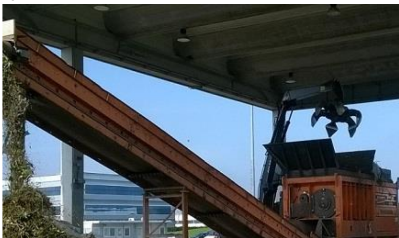
Figura 10 Particolare del trituratore
