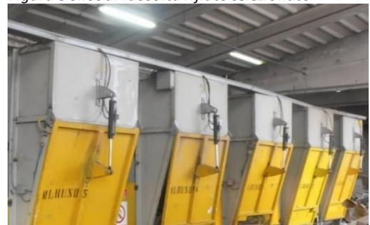
Il residuo della selezione manuale del rifiuto, denominato sovralloro, costituito in minima parte dai residui della prima vagliatura e prevalentemente dai residui della linea di selezione. Questo è scaricato, mediante nastro trasportatore, in due cassoni scarrabili dotati di presse stazionarie, per poi essere successivamente avviato ad impianti di smaltimento, in discarica, o presso impianti di termovalorizzazione.
