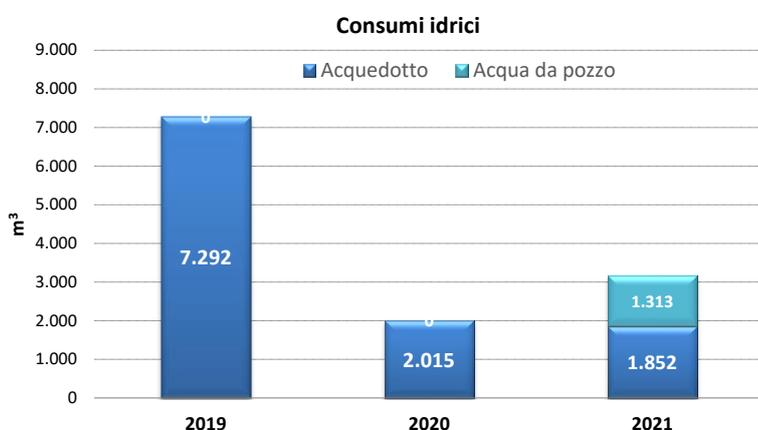
Il consumo della risorsa idrica mostra un marcato aumento nel 2019, in quanto nel periodo estivo, al fine di evitare interruzioni nella produzione di CSS a seguito di un blocco dei due trituratorini primari, è stata utilizzata acqua per il raffreddamento del sistema oleodinamico. Segue una diminuzione dei consumi nel biennio successivo conseguita grazie all'installazione del nuovo sistema di raffreddamento avvenuta nel mese di luglio 2019.
