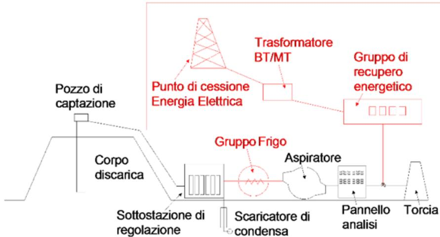
Quando il generatore è fermo per guasto o manutenzione, il biogas prodotto viene distrutto termicamente in una torcia. La torcia è sempre attiva (in stand-by) e parte in automatico ad ogni malfunzionamento che costringe al fermo il motore-generatore.
