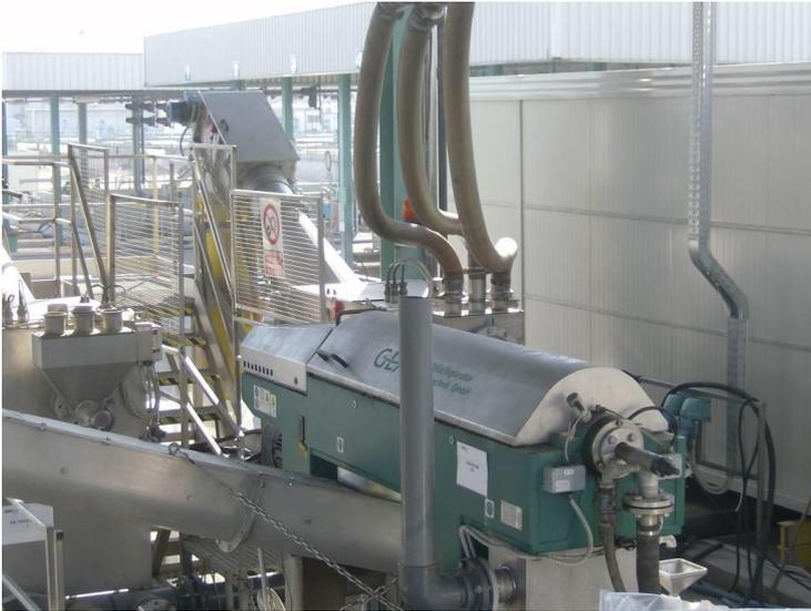
L'intera sezione impiantistica ha un'elevata efficienza di rimozione dei solidi sospesi totali, con un rendimento superiore al 90%, garantita anche dalla complementarietà delle due sezioni di filtrazione idrodinamica e di centrifugazione.
