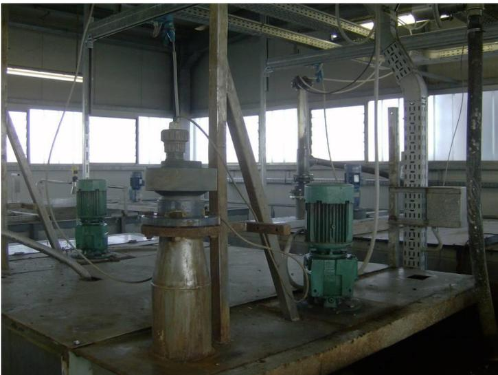
Il cuore del processo si realizza attraverso le fasi di acidificazione, alcalinizzazione, flocculazione e sedimentazione finale. L'attuale configurazione prevede, quindi, la seguente successione di stadi:
