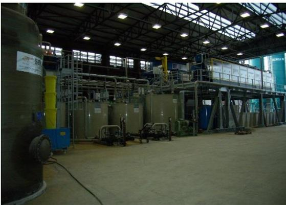
Il fango disidratato in uscita dalla filtropressa viene infine scaricato in un'area sottostante per poi essere prelevato da una pala meccanica e trasportato nell'area di deposito o nell'area di maturazione dei fanghi palabili, mentre le acque di risulta sono trasferite nelle vasche di sedimentazione delle acque di processo in attesa di essere conferite all'impianto chimico-fisico.
