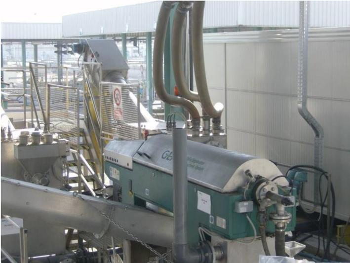
L'intera sezione impiantistica ha un'elevata efficienza di rimozione dei solidi sospesi totali, con un rendimento superiore al 99,5%, garantita anche dalla complementarità delle due sezioni di filtrazione idrodinamica e di centrifugazione.
