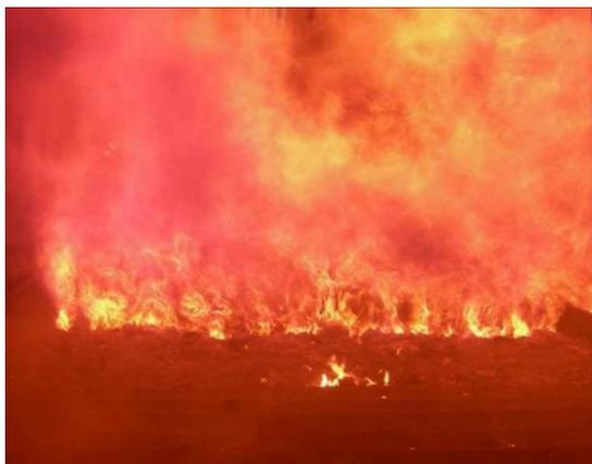
L'aria necessaria al processo di combustione dei rifiuti è distinta in aria primaria, da sottogriglia, e secondaria, in camera di combustione. Per aumentare il rendimento e diminuire le perdite, l'aria primaria, prima di essere utilizzata, viene opportunamente riscaldata con l'aiuto di scambiatori sfruttando lo spillamento di vapore proveniente dalla turbina. L'aria primaria viene prelevata dal capannone rifiuti e dall'esterno, mediante ventilatori centrifughi.
