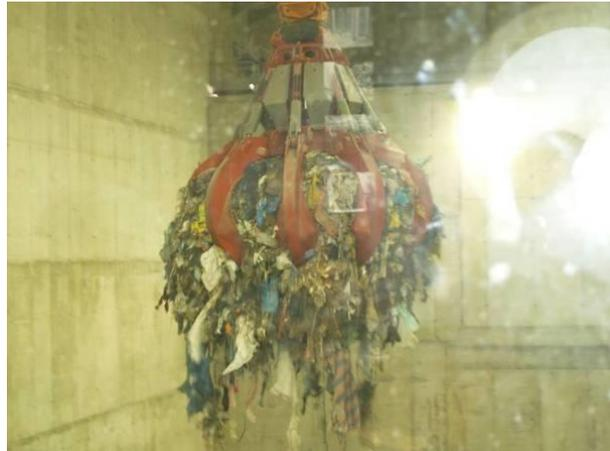
Le operazioni di caricamento del forno sono effettuate mediante benna a polipo, governata da operatore. Tale attività è svolta a ciclo continuo, coprendo quindi le 24 ore.
