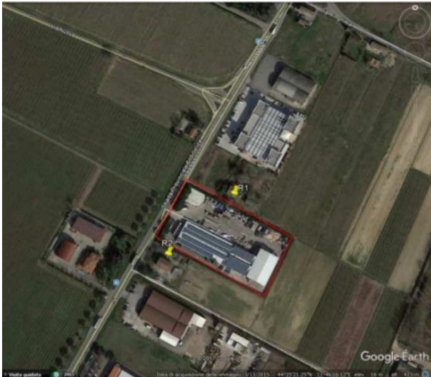
Figura 19 Individuazione dei punti di rilievo fonometrico
