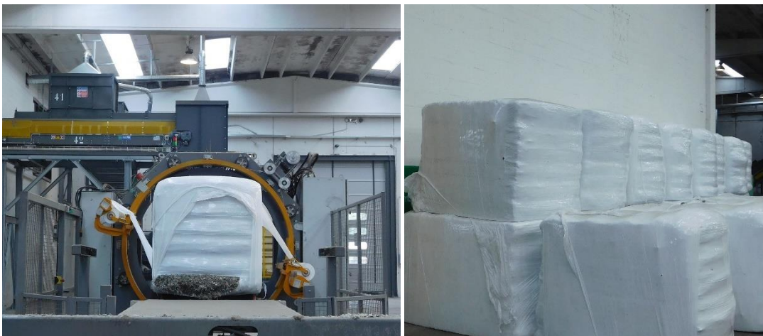
Figura 11 Particolare della pressa imballatrice con annessa filmatrice e delle balle filmate prodotte
