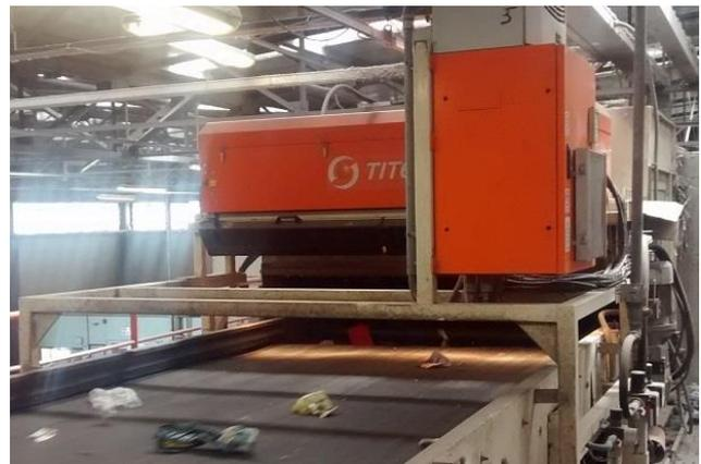
NOTA: Il materiale da smistare (1) è condotto ai sensori in modo omogeneo su un nastro trasportatore.
