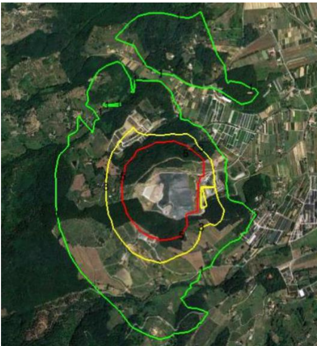
Figura 22 Mappa delle concentrazioni orarie di picco, valutate al 98esimo percentile sul dominio di simulazione (per lo scenario globale dell’impianto). FONTE: VALUTAZIONE DI IMPATTO OLFATTIVO OTTOBRE 2020.
