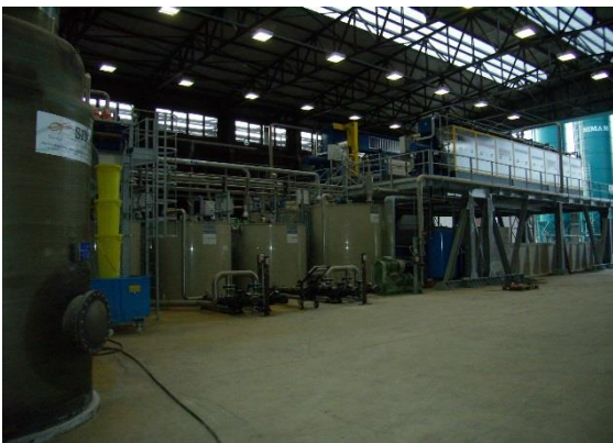
Figura 25 Sezione di filtropressatura
