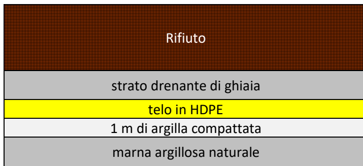
Figura 38 Struttura del fondo della discarica
