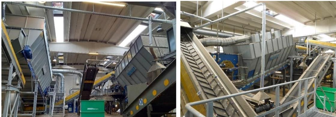
I rifiuti destinati alla produzione di CSS fine (Linea 1) e CSS medio (Linea 2) vengono alimentati ai due tritutori primari, che possono operare in parallelo oppure separatamente per la produzione di materiale fine e medio, in funzione delle esigenze di produzione. In uscita dai tritutori primari sono installati due deferrizzatori per la rimozione dei metalli ferrosi presenti.
