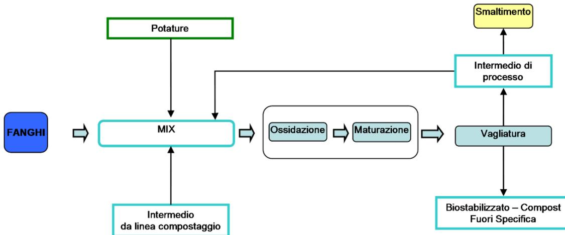
Dopo la prima fase di ricevimento e stoccaggio, la miscela di fanghi e scarti ligneocellulosici viene avviata alla successiva fase di biossidazione accelerata con l'ausilio di pala, all'interno dell'edificio di biossidazione. Il trattamento della miscela viene tuttavia effettuato in corsie dedicate e separate da quelle destinate alla produzione di compost di qualità al fine di garantire la tracciabilità del prodotto finale.
