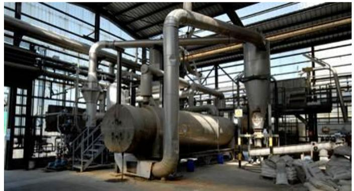
Il fango essiccato è poi miscelato con una parte del fango prodotto dalle centrifughe per ridurre la polverosità ed avviato a smaltimento in discarica.
