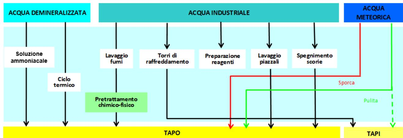
I consumi di risorsa idrica direttamente correlati al Forno F3, riportati nella tabella seguente, sono costituiti prevalentemente da acqua industriale e secondariamente da acqua demineralizzata, utilizzata all'interno del ciclo termico. Nel periodo di riferimento i consumi idrici totali presentano delle variazioni in quanto influenzati dalle attività di revamping. In particolare, i consumi per l'anno 2022 e 2023 sono legati sia alle attività di cantiere che alla fase di avviamento dell'impianto.
