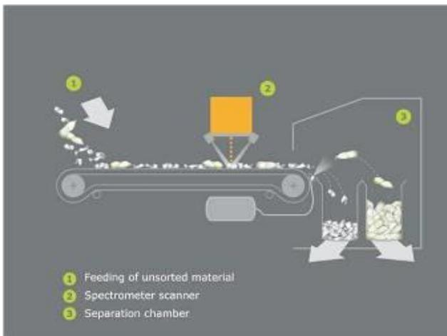
NOTA: Il materiale da smistare (1) è condotto ai sensori in modo omogeneo su un nastro trasportatore.
