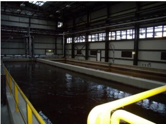
Nella vasca di stoccaggio in ingresso, i fanghi vengono omogeneizzati e trasferiti o alla sezione di lavorazione dei fanghi palabili (linea di inertizzazione/condizionamento), che costituisce la destinazione prevalente di
