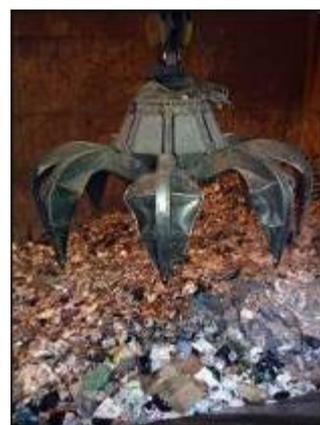
I rifiuti sono scaricati nella fossa di ricezione tramite dieci porte di accesso e tramite l'utilizzo di due (uno di riserva all'altro) carriponte dotati di benne idrauliche sono immessi nelle tramogge di alimentazione per la combustione. Rappresentiamo i grafici indicanti la quantità di rifiuti trattati dal termovalorizzatore nell'ultimo triennio.
