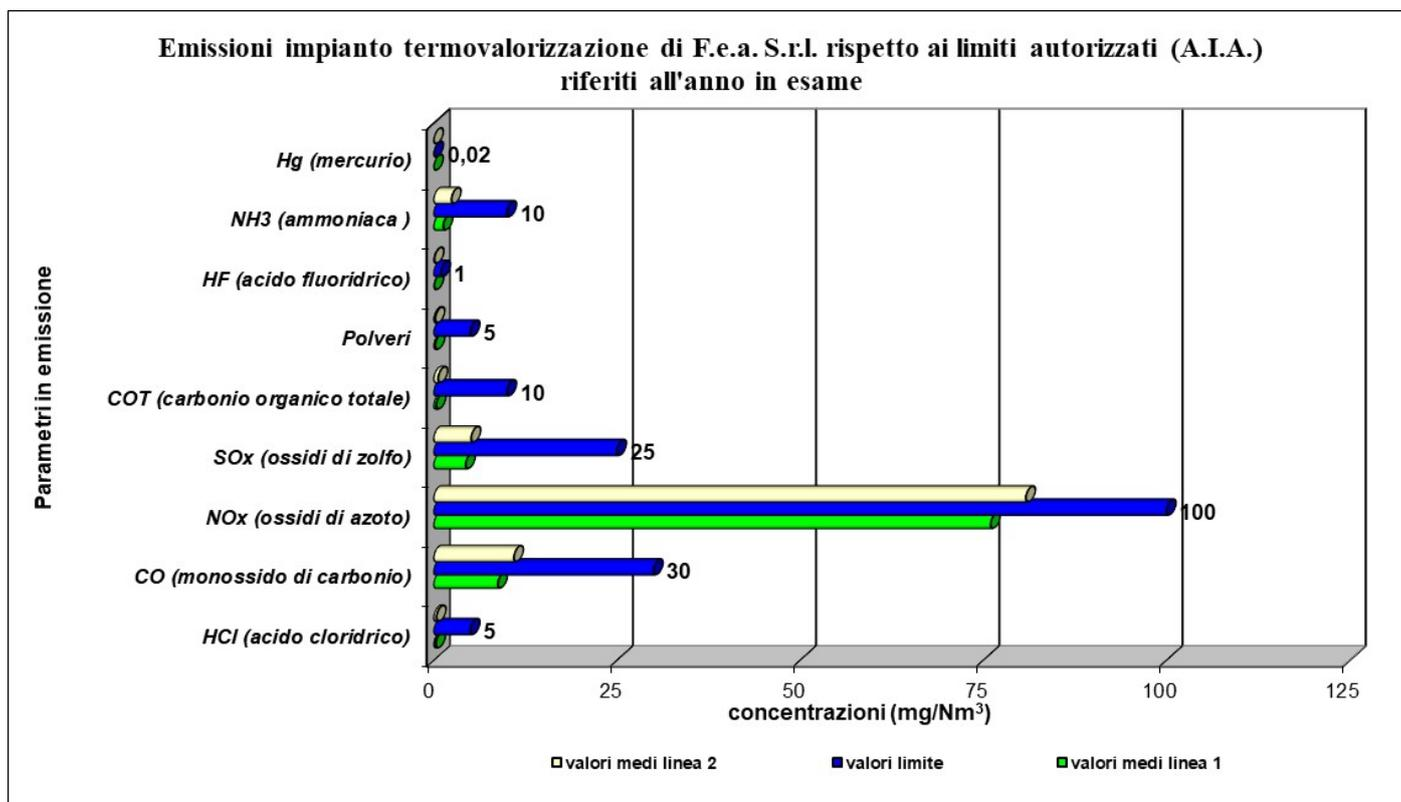
Riportiamo di seguito le principali emissioni delle linee di trattamento n.1 (E3) e n.2 (E2), monitorate dal sistema analisi in continuo, espressi come valori medi giornalieri in mg/Nm<sup>3</sup> normalizzati, secondo D.Lgs.152/06, comparati con il rispettivo valore limite previsto dall'A.I.A.
