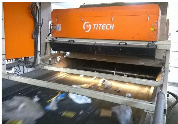
NOTA: Il materiale da smistare (1) è condotto ai sensori in modo omogeneo su un nastro trasportatore.
