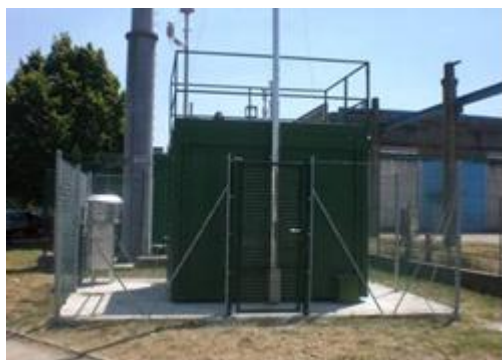
Figura 39 Centralina di monitoraggio qualità dell'aria
