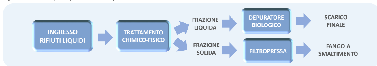
Figura 1 Schema tipo impianto chimico-fisico
