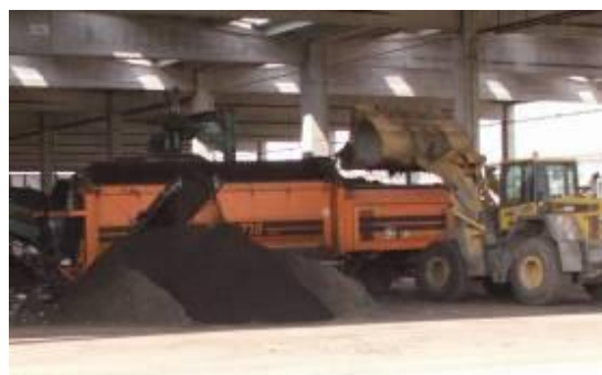
Figura 13 Operazioni di vagliatura
