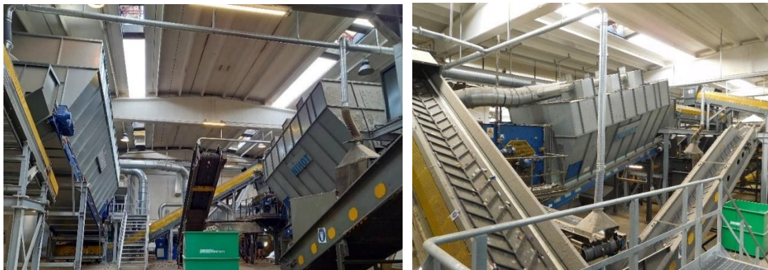
Figura 8 Particolare Linea 1: a sinistra i due separatori aeraulici e a destra i nastri trasportatori e il separatore aeraulico
